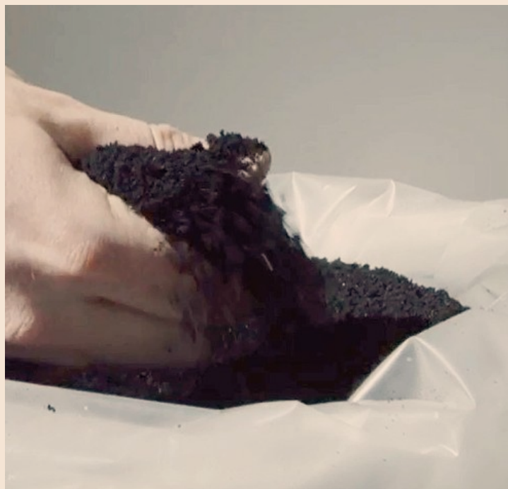
Pneumatici devulcanizzati. Niente zolfo e molecole intatte
